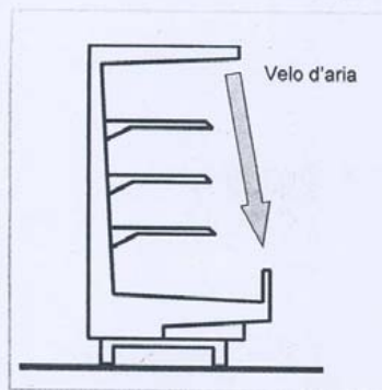
Figura 1 - Spaccato tipo di un mobile verticale aperto
