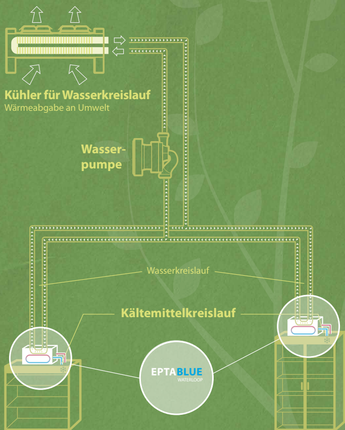
EptaBlue Waterloop: eine intelligente Kälteanlage für Raststätten und Convenient Stores.
