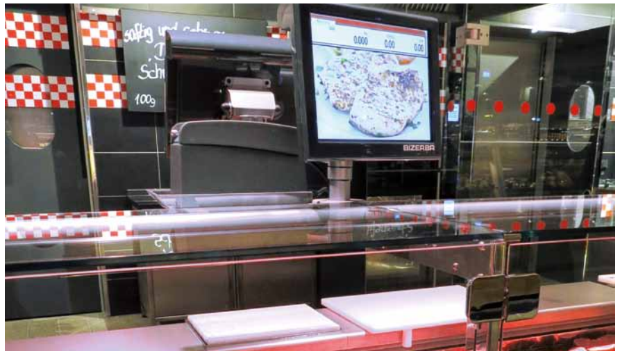
Über das Display der neuen Bizerba-Wägelösung in der Eurocryor-Bedienungstheke erhalten Kunden zusätzliche Produktinformationen. Das Wägebrett wurde nach den Anforderungen von EDEKA in die Arbeitsplatte integriert.
